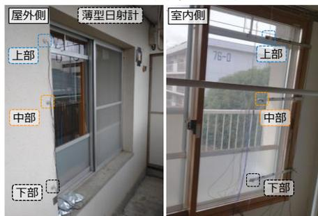
写真1: DI窓の外観および日射量計測の様子
